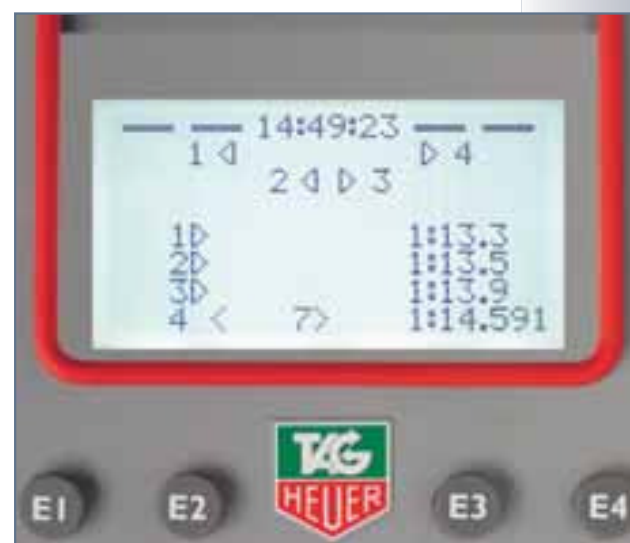
L'affichage rétro-éclairé de 8 lignes à 21 caractères offre beaucoup de confort
